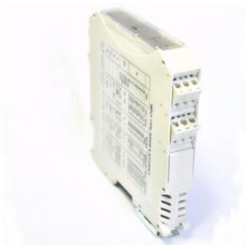
FS-2212 万能信号隔离器是风讯仪表最新推出的新一代二入二出万能输入型信号隔离器，与传统的信号隔离器不同，FS-2212 可接受工业过程控制中的各种信号类型, 包括: 热电偶, 热电阻, 电阻, mA, 电压等信号, 隔离输出为 4-20mA 的标准工业信号, 其中, 输入信号类型, 信号量程和分度号可以通过 USB 编程适配器 (FS-001 USB) 在免费的上位机设置软件中 (FS-001) 任意配置和修改, 采用 FS-2212 万能输入型信号隔离器极大地简化了现场设备安装维护及备品备件的数量, 真正实现了对工业现场的灵活快速响应。
