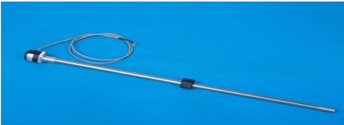
**FL-932 磁感应油缸系列位移传感器**，有效行程 50mm~2000mm（最大可以达到 5000mm 以上），可以适用于油缸位移运动的测量。结构简单、[原理先进](#)、抗干扰能力强，允许运动速度 2m/s。有[电阻型](#)、电压型、电流型（3 线和 2 线）、脉冲型 4 种输出。本安防爆认证。耐压等级 15MPa,35MPa。
