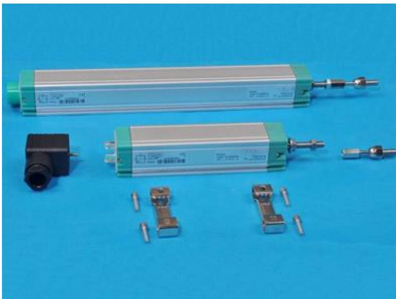
[FL-902 拉杆系列直线位移传感器](#)用于对位移或者长度进行精确测量。测量行程 75mm~1250mm，两端均有 4mm 返冲行程，线性精度 0.1%~0.04%FS，重复精度±0.013mm。[传感器的](#)结构设计保证安装方便，牢固可靠。外壳进行了阳极处理，外观靓丽，抗腐蚀，内置导电塑料测量单元，无温漂，寿命长，保证运行顺滑。密封防护等级 IP67，DIN430650 镀银插座，适用范围广信号传输更稳定，拉杆球具有 0.5mm 自动对中功能，公司从国外进口的专用线性修刻系统，[电阻](#)修刻技术不仅可以满足您的线性度要求，而且可以根据客户的要求修刻电阻值的大小。
